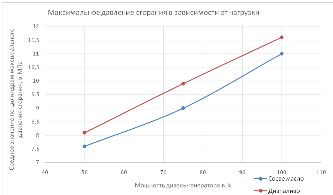
рис.4 Максимальное давление сгорания в зависимости от нагрузки
