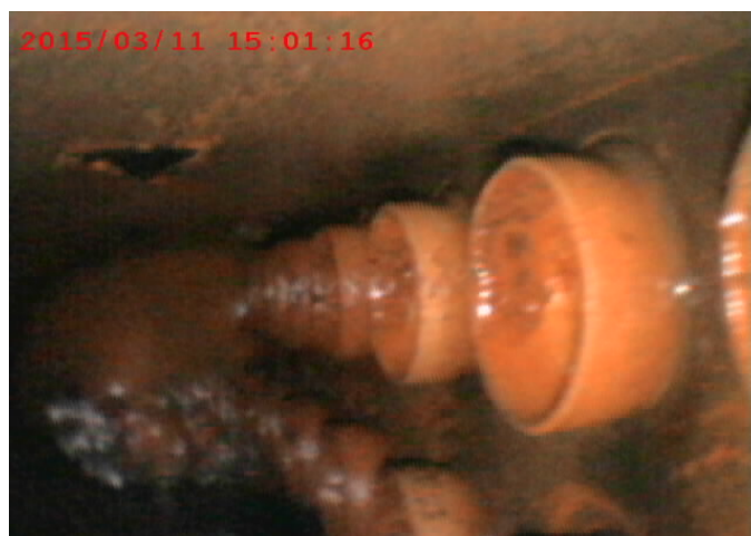
Фото 1. Мазеобразные отложения в нижнем резиновом патрубке радиатора (а) и коррозия в трубках радиатора (б)
