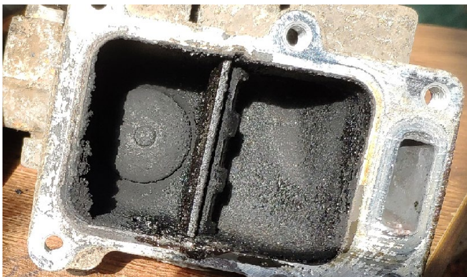
Рис.2. Отложения на тарелке клапана системы EGR.
