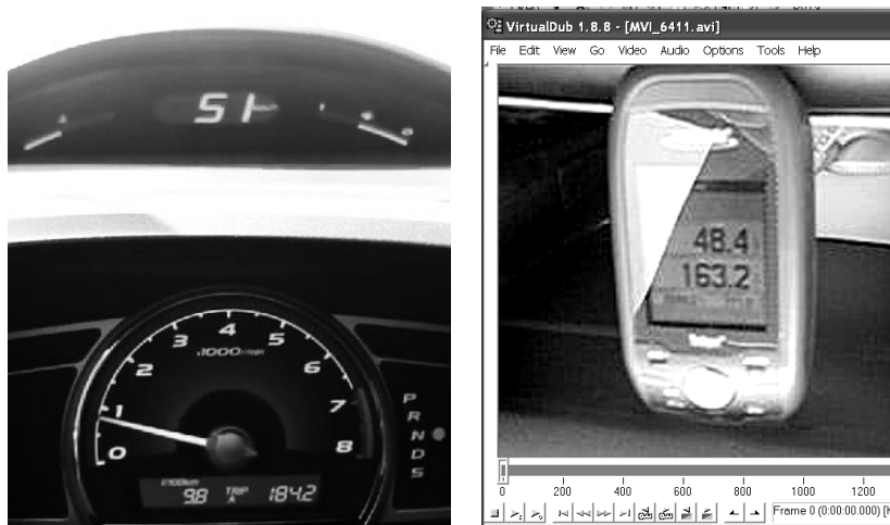
Фиг. 3. Синхронные кадры видеозаписей спидометра и тахометра и приемника сигналов GPS Magellan Triton 300 (с экрана программы Virtual Dub)
