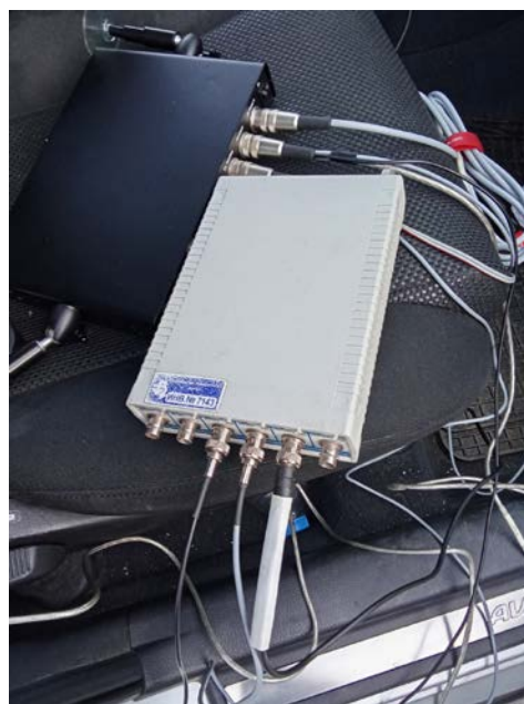
Фиг. 5. Осцилоскоп събиращ данните от изброените канали
